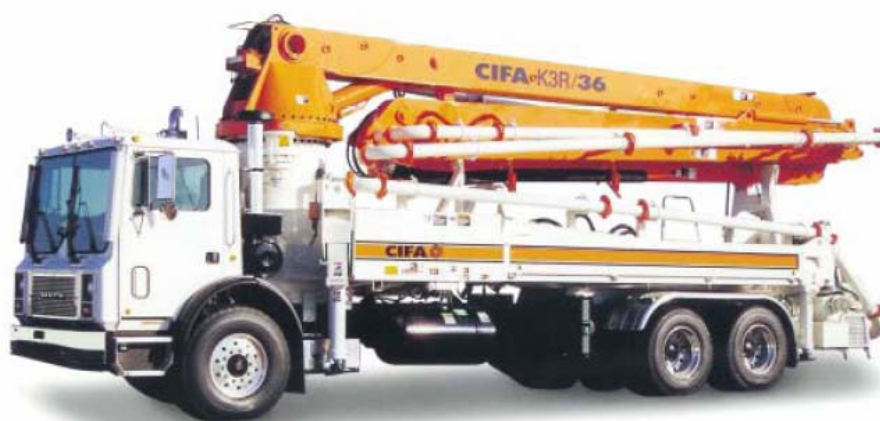
پمپ کامیونی متداول تیرک دار دارای سه بازو مجهز به جک
